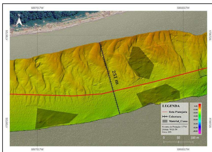
Figura 5 - Presença de Material Coeso, a faixa investigada era ampliada para 200 m, possibilitando a avaliação de alternativas de traçado e a busca por corredores mais favoráveis para o posicionamento da RPL.
